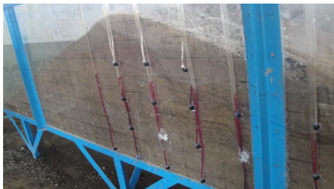
شکل 2: پیزومترها نصب شده روی بدنه فلوم برای اندازه گیری فشار
