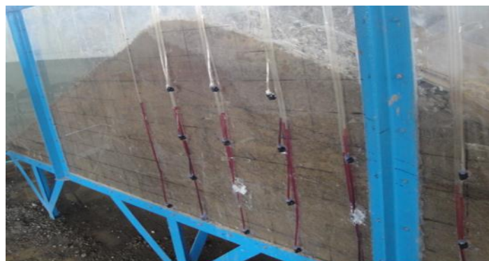
شکل ۲: پیزومترها نصب شده روی بدنه فلوم برای اندازه گیری فشار
