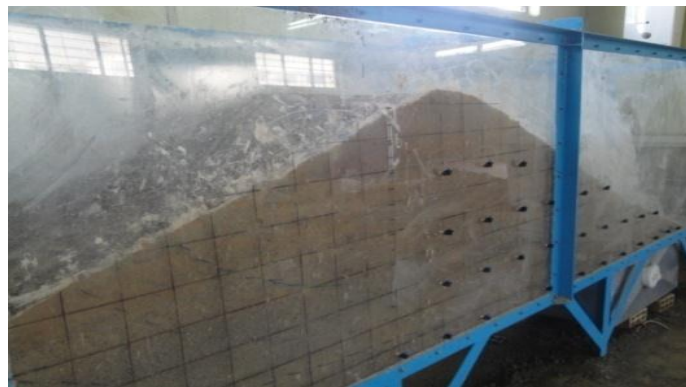
شکل ۱: مدل آزمایشگاهی سد خاکی همگن در فلوم آزمایشگاهی
